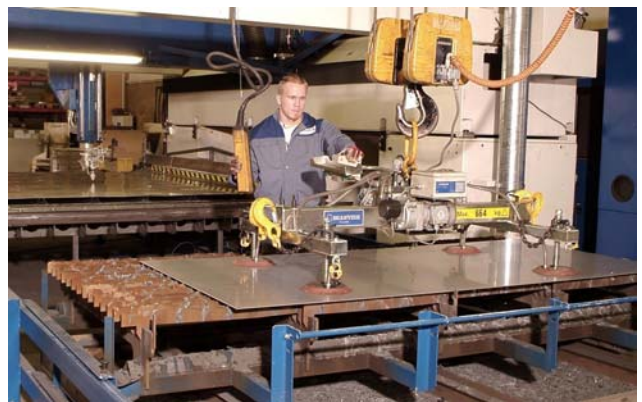
Vakuumlyftok används för matning vid laserskärning/-svetsaggregat.
