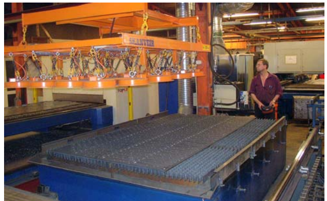
Magnetlyftok används för matning vid plasmaskärningsmaskin. Lyft av plåtar och bitar samtidigt.
